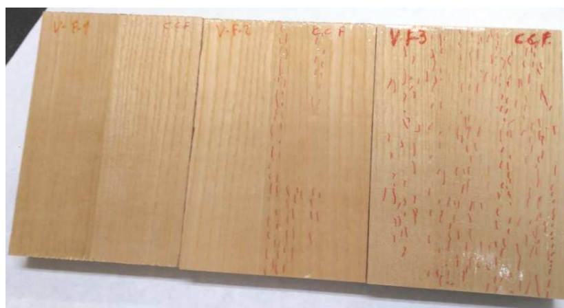
Figura 24. Muestras con película de acabado con recubrimiento híbrido aplicada sobre haya. De izquierda a derecha 100 – 200 – 300 g/m 2 . En rojo se han marcado las grietas detectadas. Figura 71, entregable 2.2
