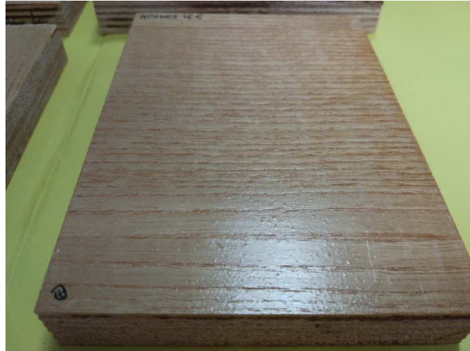
Figura 28. Detalle del recubrimiento sobre Fresno de la Formulación APDMES 1.5E aplicado con pincel.
