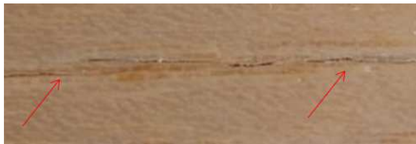
Figura 13. Muestra M0_f tras 40 ciclos de cold-check Imagen con equipo de análisis a 6,5x. Gritas finas lineales debidas al agrietamiento de los poros del fresno. Aparecen en menor cantidad que en el soporte en crudo. Figura 31, entregable 2.2.
